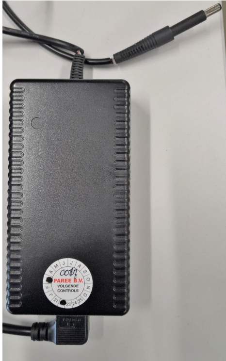
Oplader Fluke DC500 adapter, draden bloot/zichtbaar
